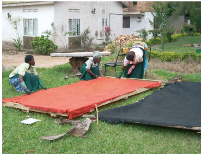
9. Das fertige Tuch wird auf einen Rahmen gespannt. Anschließend wird es auf einen Vliesuntergrund laminiert, um so eine hochwertige Wandbekleidung herzustellen.
