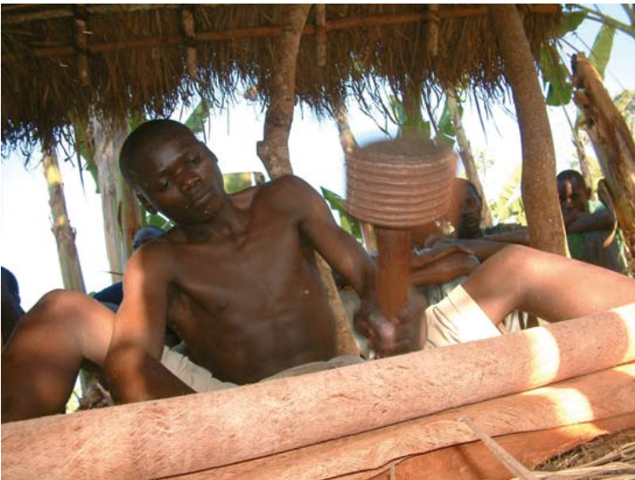
4. Die Rinde wird solange mit einem hammerähnlichen Werkzeug bearbeitet, bis die gewünschte Geschmeidigkeit erreicht ist und aus der Rinde ein Tuch wurde.
